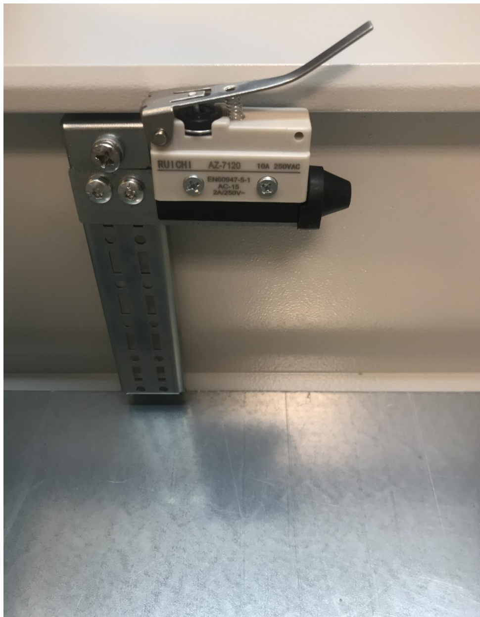
Рис.3.1.9-1 Установленная шина внутреннего монтажа совместно с датчиком вскрытия
