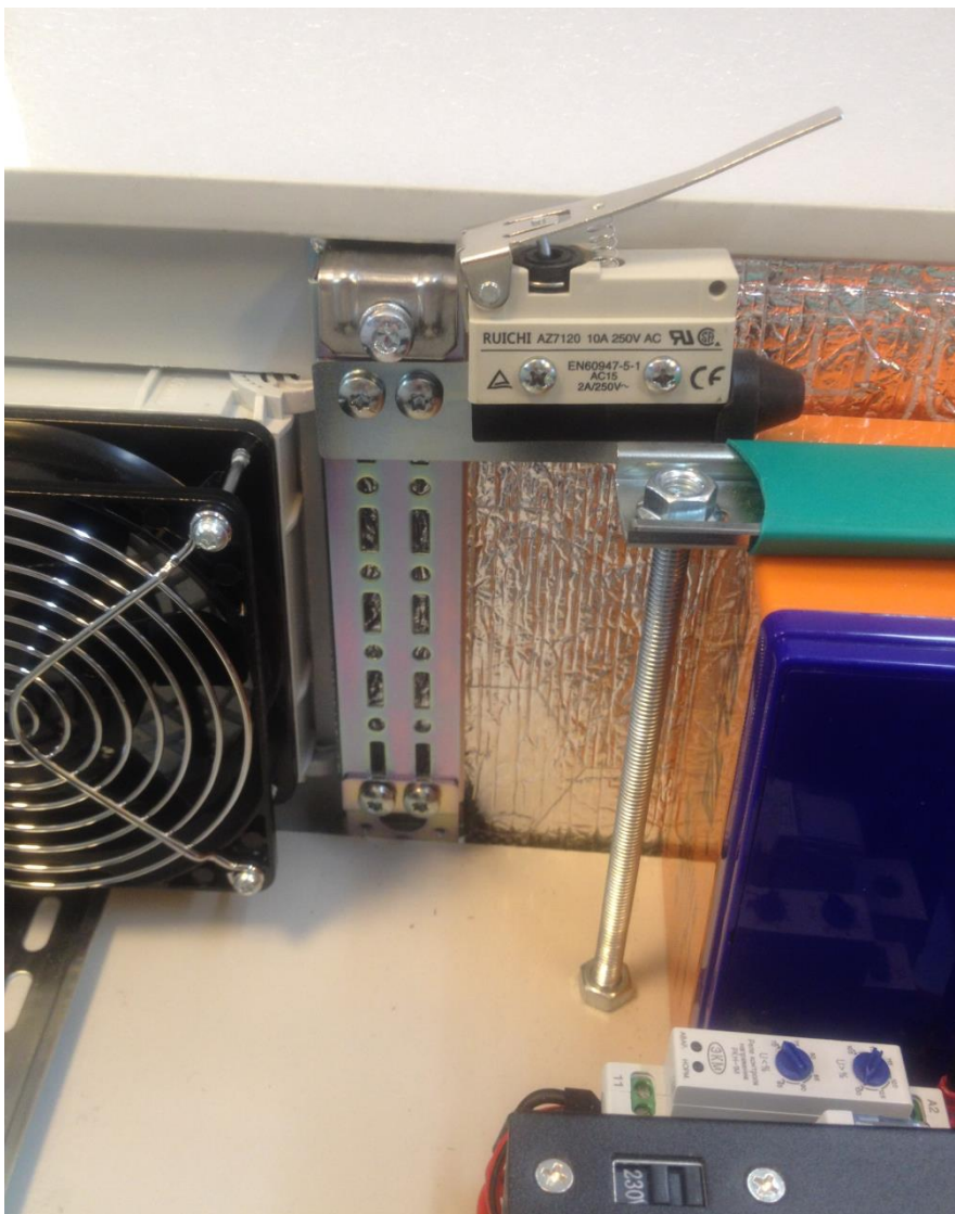
Рис.3.2.10-1 Установленная шина внутреннего монтажа совместно с датчиком вскрытия
